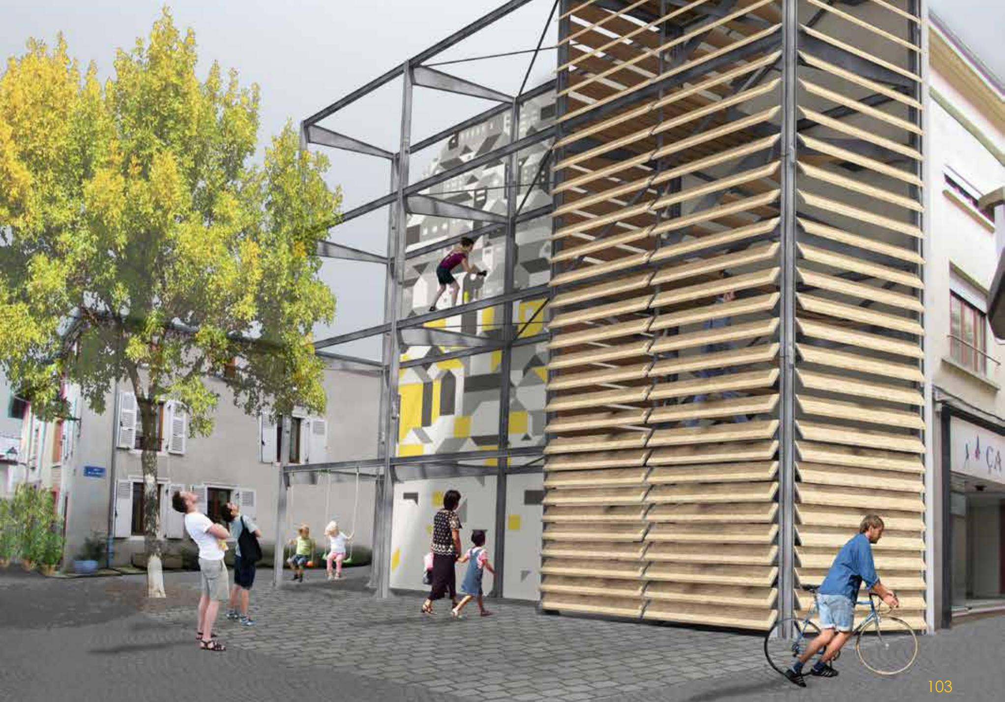
Le scénario projette la démolition de ce bâtiment avec la mise place d'une structure d'étaieement de type "isolée" accueillant un belvédère. Ce type d'étaieement nécessite la création d'une fondation spécifique [voir annexe 2.05]
